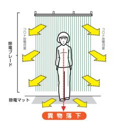
コロナ放電効果によって身体の静電気を 除去し、静電気でくっついた、取り除き にくい毛髪やホコリ等を歩行する際の 振動で自然落下させます。
