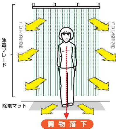
コロナ放電効果によって身体の静電気を除去し、静電気でくっついた、取り除きにくい毛髪やホコリ等を歩行する際の振動で自然落下させます。ローラー掛けやエアシャワーによる異物除去率の向上が期待できます。除電ブレードと除電マットを併用するとさらに除電の効果が高まります。
